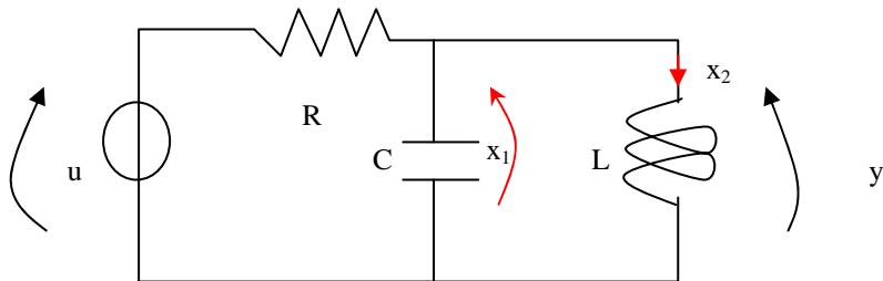
1.2 Si scriva la funzione di trasferimento del sistema (si ponga  $a=RC$ ,  $b=LC$ ) e si dica (aiutandosi con grafici) come cambia la risposta allo scalino (guadagno, oscillazioni, etc...) in funzione dei due parametri  $a, b$ .
