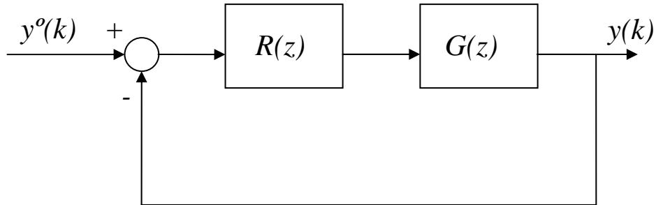
Si sintetizzi  $R(z)$  del minimo ordine possibile in maniera tale che l'errore sia nullo dopo un numero finito (e più piccolo possibile) di passi quando il riferimento  $y^o(k)$  è uno scalino.
