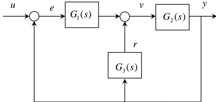
Si consideri il sistema dinamico con ingresso  $u$  e uscita  $y$  raffigurato nello schema a blocchi in figura, dove  $G_1(s)$ ,  $G_2(s)$  e  $G_3(s)$  sono le seguenti funzioni di trasferimento di sistemi del primo ordine:
