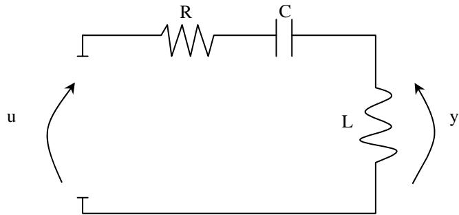
Si consideri il sistema elettrico in figura dove  $u(t)$  è la tensione di ingresso,  $y(t)$  la tensione di uscita, e i parametri  $R, C, L$  sono quelli della resistenza, della capacità e dell'induttanza dei dispositivi schematizzati.
