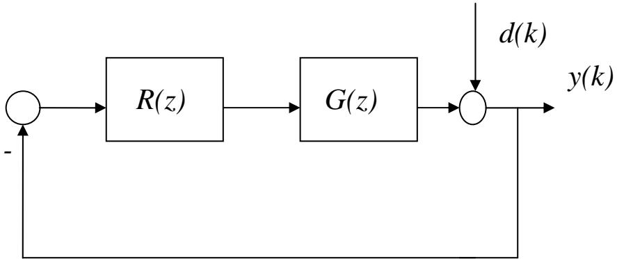
Si sintetizzi  $R(z)$  del minimo ordine possibile in maniera tale che l'errore sia nullo dopo un numero finito (e più piccolo possibile) di passi quando il disturbo  $d^o(k)$  è uno scalino.
