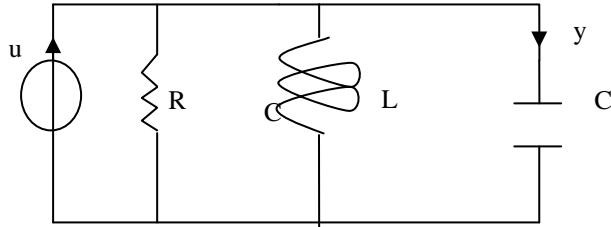
1.2 Si scriva la funzione di trasferimento del sistema dalla corrente  $u$  alla corrente  $y$  e si dica (aiutandosi con grafici) come cambia la risposta allo scalino (guadagno, oscillazioni, etc...) in funzione dei due parametri  $a=RC$ ,  $b=LC$ .
