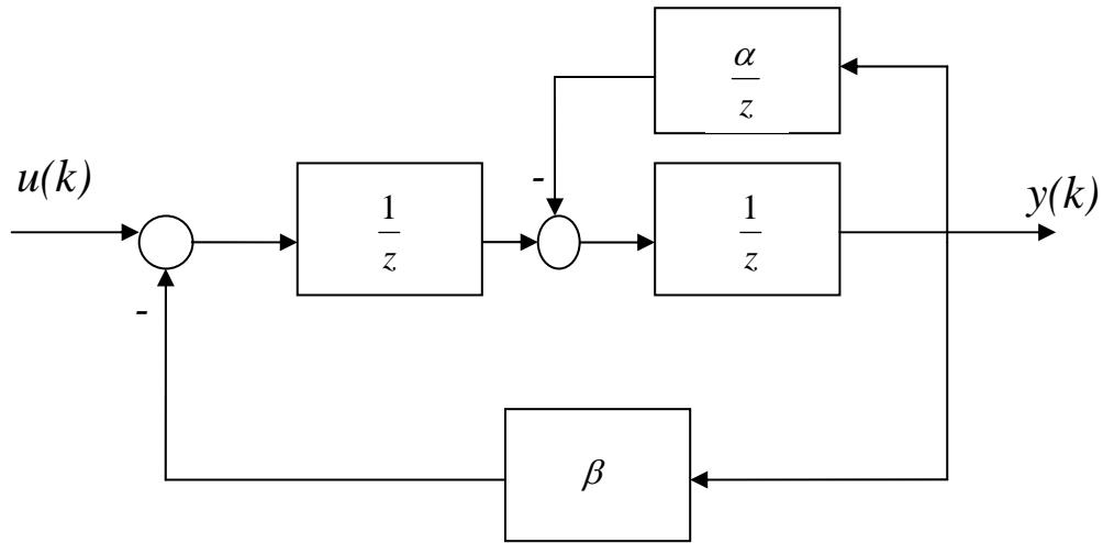
Si studi la stabilità interna del sistema in funzione dei parametri reali  $\alpha, \beta$ .
