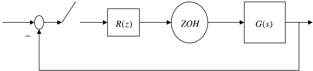
Con riferimento al sistema di controllo digitale riportato in figura (il campionatore - ideale a cadenza uniforme - e il mantenitore ideale - di ordine zero – operano in sincronia e in fase), si enuncino, a parole, i passi che conducono al progetto di un regolatore digitale secondo il “punto di vista analogico”.
