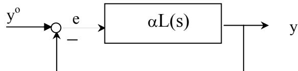
dove  $\alpha$  è un parametro reale e  $L(s)$  è la funzione di trasferimento di un sistema del secondo ordine. In figura è disegnata la risposta dell'errore  $e(t)$  al segnale di ingresso
