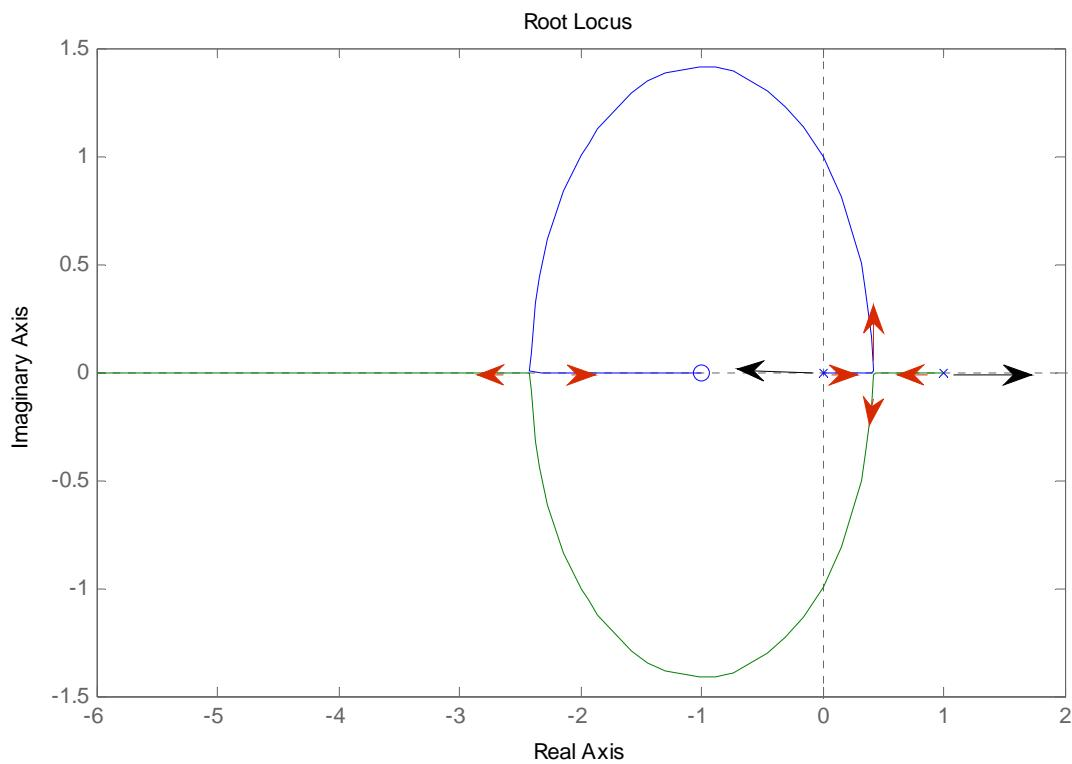
$s^2 - s + 9\alpha(s+1) = s^2 + s(9\alpha - 1) + 9\alpha$ . Per  $\alpha > 1/9$  il sistema retro azionato è asintoticamente stabile.
