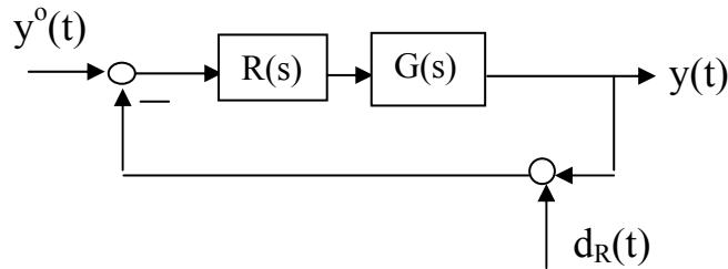
Sia  $y^0(t) = sca(t)$  e  $d_R(t) = \sin(10t)$ . Si sintetizzi un regolatore  $R(s)$  in modo tale che:
