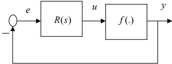
dove il sistema lineare con funzione di trasferimento  $R(s)$  è descritto dalle equazioni di stato
