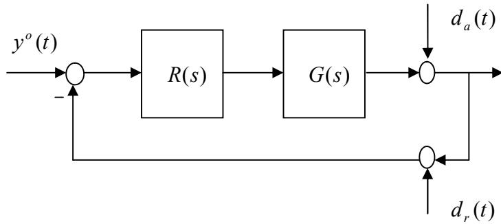
Si consideri il sistema di controllo in figura, dove  $G(s) = \frac{2-s}{(s+1)(s+5)}$ ,  $y^o(t) = sca(t)$ ,  $d_r(t) = \sin(20t)$ ,  $d_a(t) = \sin(0.05t)$ .
