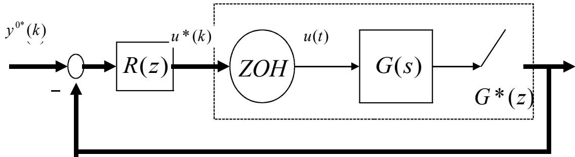
Si faccia riferimento al sistema di controllo digitale riportato in figura (il campionatore - ideale a cadenza uniforme - e il mantenitore ideale - di ordine zero – operano in sincronia e in fase con periodo  $T > 0$ ),  $G(s) = \frac{1}{s}$  e  $R(z) = \frac{1}{z}$ .
