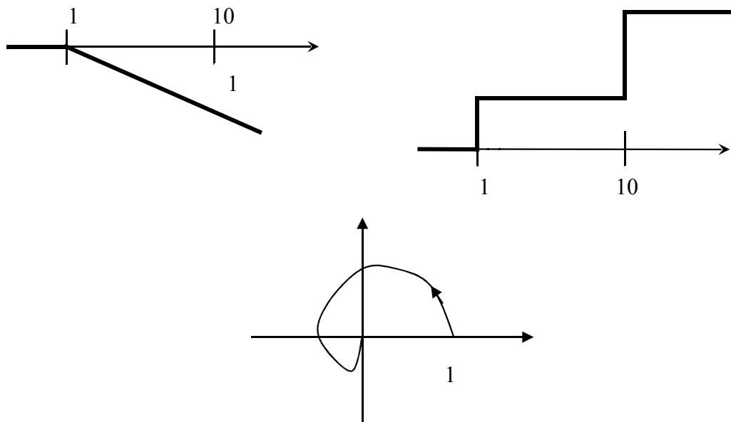
Il punto in cui il diagramma polare ha fase uguale a 180 gradi è  $-1/11$ . Il numero di giri del diagramma di Nyquist di  $L(s)$  intorno al punto  $-1$  in senso antiorario è 2 se e solo se  $\alpha > 11$ . Questa è la condizione di asintotica stabilità del sistema retro azionato.
