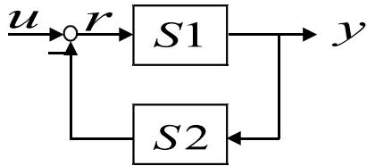
dove il sottosistema S1 (ingresso  $r(t)$  uscita  $y(t)$ ) è descritto dalle equazioni di stato
