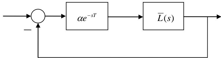
Si caratterizzino tutti i valori (positivi) dei parametri ( $\alpha, T$ ) tali che il sistema in anello chiuso in figura sia asintoticamente stabile.
