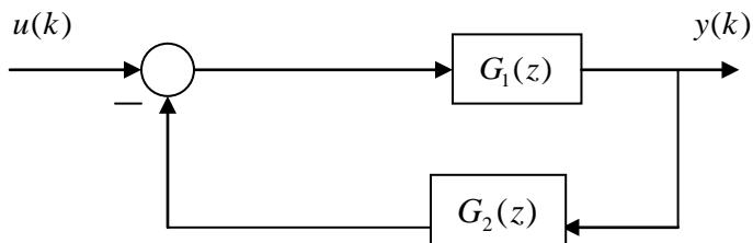
dove  $G_2(z)=1$ . Si ricavi una descrizione in variabili di stato del sistema  $G_1(z)$  compatibile con la risposta  $y(k)$  ad uno scalino  $u(k)$  riportata nella figura seguente:
