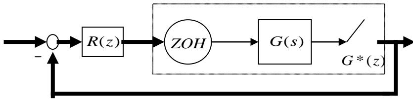
Si faccia riferimento al sistema di controllo digitale riportato in figura (il campionatore - ideale a cadenza uniforme - e il mantenitore ideale - di ordine zero – operano in sincronia e in fase con periodo  $T=1$ ),  $G(s) = \frac{e^{-s}}{s}$  e  $R(z) = \frac{\alpha}{z}$ .
