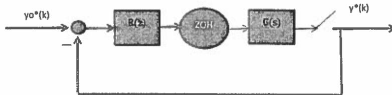
Si consideri il sistema di controllo digitale in figura, dove i convertitori operano in sincronia e in fase,  $y^{0*}(k) = sca^*(k)$  e
